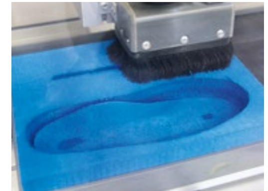
Einlage wird mit der CNC-Fräse gefertigt.
